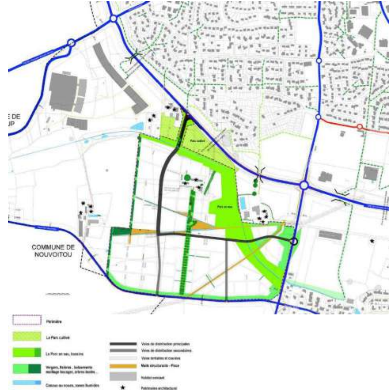
Figure 56 : Schéma général d'aménagement projeté - Les espaces publics (trames verte et bleue, trame viaire)
