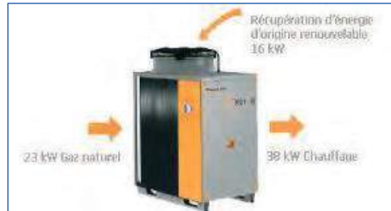
Figure 60 : Principe de l'aérothermie au gaz naturel
